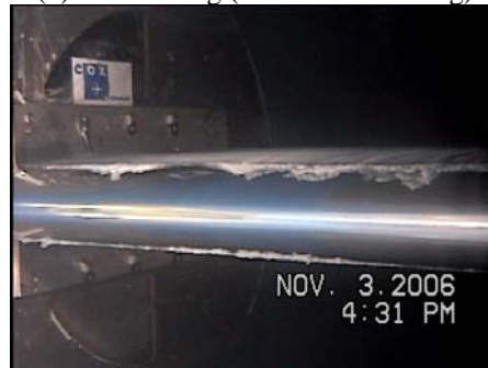
(d) Post deicing (44 minutes in icing)
